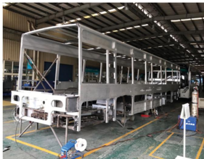
Die Aluminiumkarosserie wird auf das Stahl-Fahrgestell montiert
